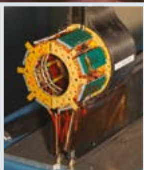
1–2. kép. A PLT (Pixel Luminosity Telescope) detektor, amelynek gépi tanuláson alapuló adatminőség-ellenőrzését az ELTE diákjai fejlesztették ki.
